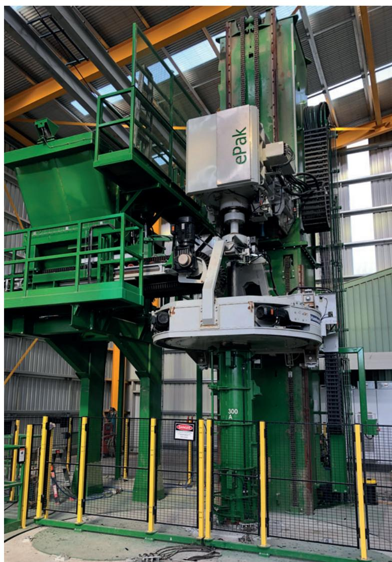
*La machine HawkeyePedershaab ePak est idéale pour la production en série de tuyaux à profil rond. Elle produit des tuyaux de haute qualité avec une surface exceptionnellement lisse et est idéale pour la production de tuyaux à paroi mince.*
