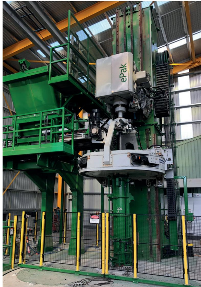
Die HawkeyePedershaab ePak-Maschine ist ideal für die Massenproduktion von Rohren mit rundem Profil. Sie produziert qualitativ hochwertige Rohre mit einer außergewöhnlich glatten Oberfläche und ist ideal für die Herstellung dünnwandiger Rohre geeignet.
