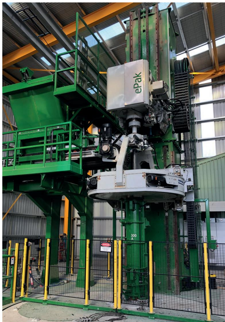
*La macchina ePak di HawkeyePedershaab è l'ideale per la produzione in massa di tubi con il profilo circolare. Produce tubi d'alta qualità con una superficie estremamente liscia ed è l'ideale per la produzione di tubi sottili.*
