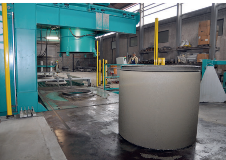
Die fertigen Produkte werden automatisch aus der Maschine geschoben.
