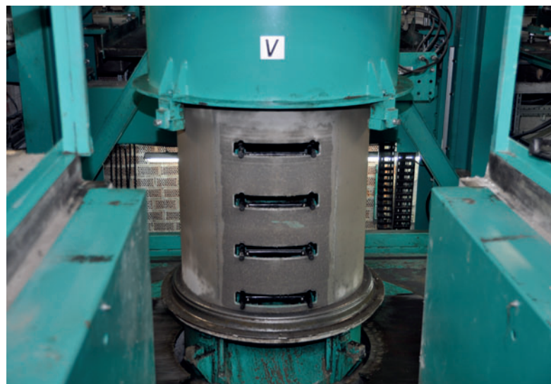
Formkern mit hydraulischem Schild für die Produktion von Schachtringen mit Steigeisen
