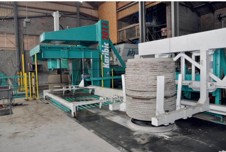
Die Karibic 2011 wurde mit einem Muffenmagazin mit einer vollautomatischen Muffenablagevorrichtung ausgestattet.
