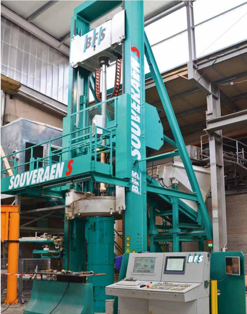
Neue HP-BF - Ideen – zusätzlicher Nutzen für unsere Kunden: Die BFS- Liner-Einpressanlage kann in neue oder in bestehende Betonrohr-Maschinen integriert werden. Sie erweitert als Zusatzoption die Produktbandbreite der BFS-SOUVERAEN-Anlage.
