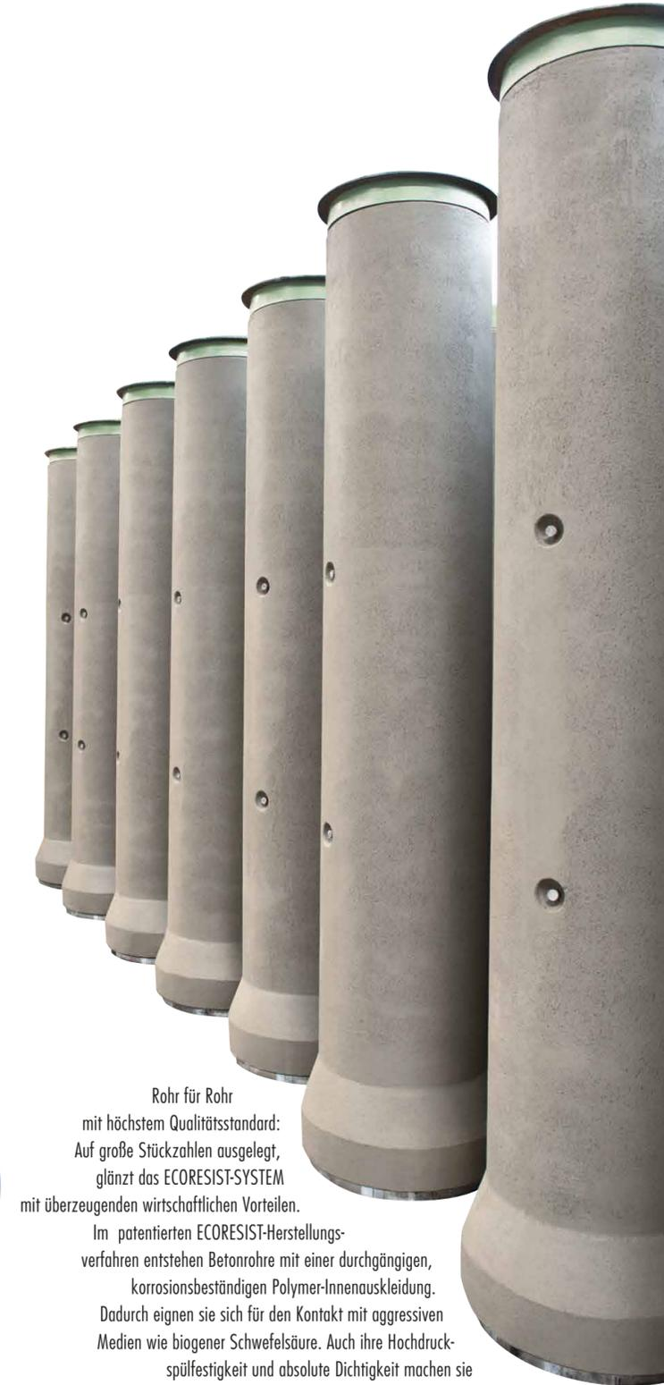
Rohr für Rohr mit höchstem Qualitätsstandard: Auf große Stückzahlen ausgelegt, glänzt das Ecoresist-SYSTEM mit überzeugenden wirtschaftlichen Vorteilen. Im patentierten Ecoresist-Herstellungsverfahren entstehen Betonrohre mit einer durchgängigen, korrosionsbeständigen Polymer-Innenauskleidung. Dadurch eignen sie sich für den Kontakt mit aggressiven Medien wie biogener Schwefelsäure. Auch ihre Hochdruckspülfestigkeit und absolute Dichtheit machen sie zur ersten Wahl für langlebige Kanalsysteme.
