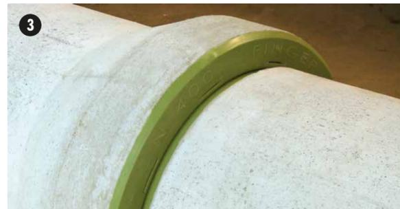
Der Formschluss zwischen Beton- und Polymer-Rohr bildet sich in Folge der Schrumpfung während der Betonaushärtung. Diese Polymereinnauskleidung kann Längenausdehnung durch Temperaturschwankungen ausgleichen.
