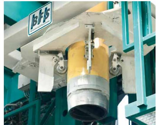
ECORESIST Durch die gemeinsame Steuerung von Beton- und Liner-Anlage verzahnen sich die Arbeitstakte perfekt. Sobald der Formmantel mit dem frischen Rohr in die Einpresstation geschwenkt ist, wird das Polymerrohr von oben eingepresst.
