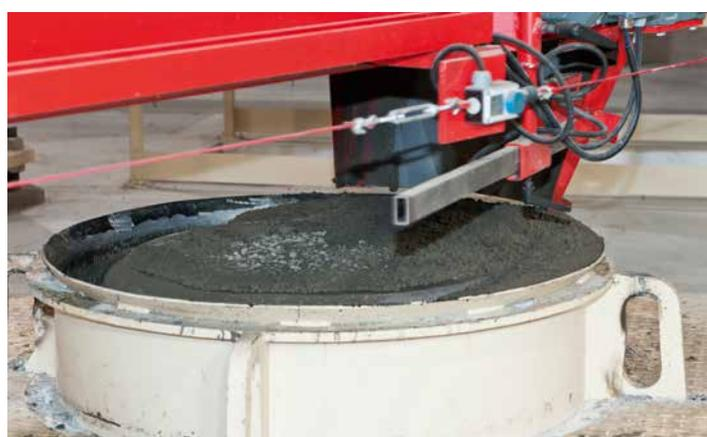
Il sistema rotante di alimentazione del calcestruzzo, unitamente al nastro rotante di distribuzione, consente un accurato ed affidabile riempimento della cassaforma. Un apposito sistema a controllo di frequenza garantisce che il trasporto di calcestruzzo venga permanentemente regolato consentendo la migliore adattabilità qualsiasi tipologia di prodotto.
