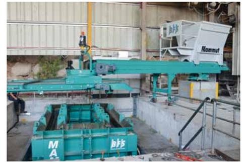
Der Bunker des Betonbeschickers wird per Förderband oder Kübelbahn befüllt.
