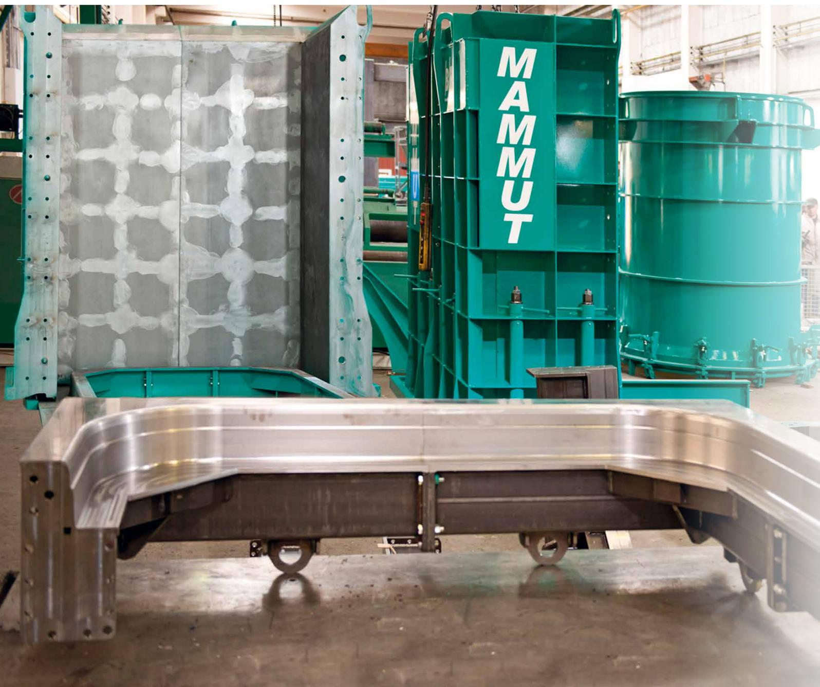
Innenformen, Außenformen, Untermuffen, Spitzendformer – alles aus dem Modularbaukasten reduziert Investitionskosten und erhöht die Produktionsflexibilität. MAMMUT-Formen können ausgestattet werden mit:
