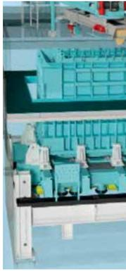
Mit stabilen hydraulischen Klemmböcken wird der Mantel samt Untermuffe auf dem Rütteltisch verspannt ...
