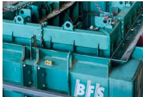
Beim Spitzendformer ist jede gewünschte Fügung möglich. Das Spitzende wird mittels acht im Formmantel integrierter hydraulischer Klemmzylinder unter Vibration ausgeformt. Auch dieser Abschnitt der Fertigung läuft vollständig automatisiert ab. Alle Parameter sind über den integrierten Touch-Bildschirm frei wählbar.
