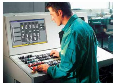
S-Flex – Il sistema per il cambio dei diametri. Sistema che consente di cambiare l'assetto della macchina in tempi rapidi (da 15 a 60 minuti in funzione delle dimensioni). Contemporanea modifica di tutti i parametri di base tramite azionamento di un semplice pulsante.
