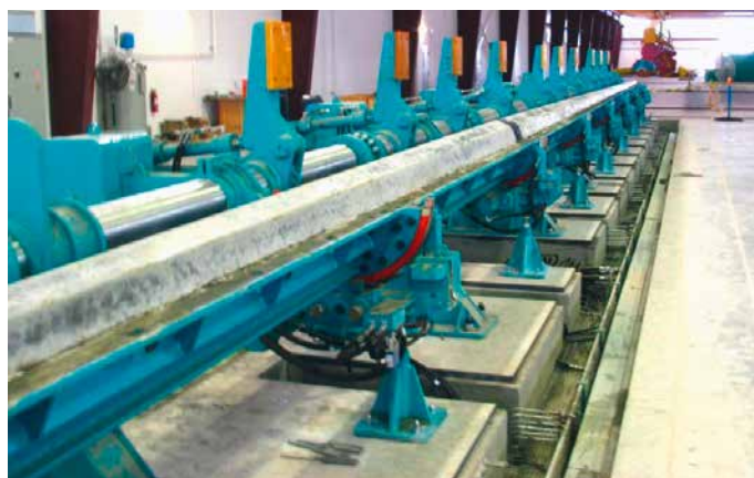
Пост автоматической распалубки
