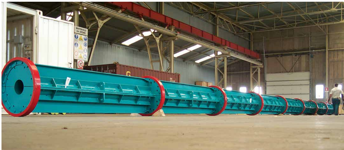
Собранная форма для производства столбов методом центрифугирования
