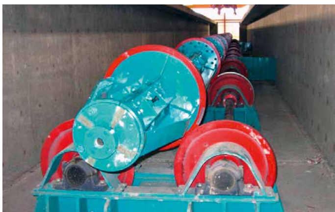
Форма, установленная на центрифугу
