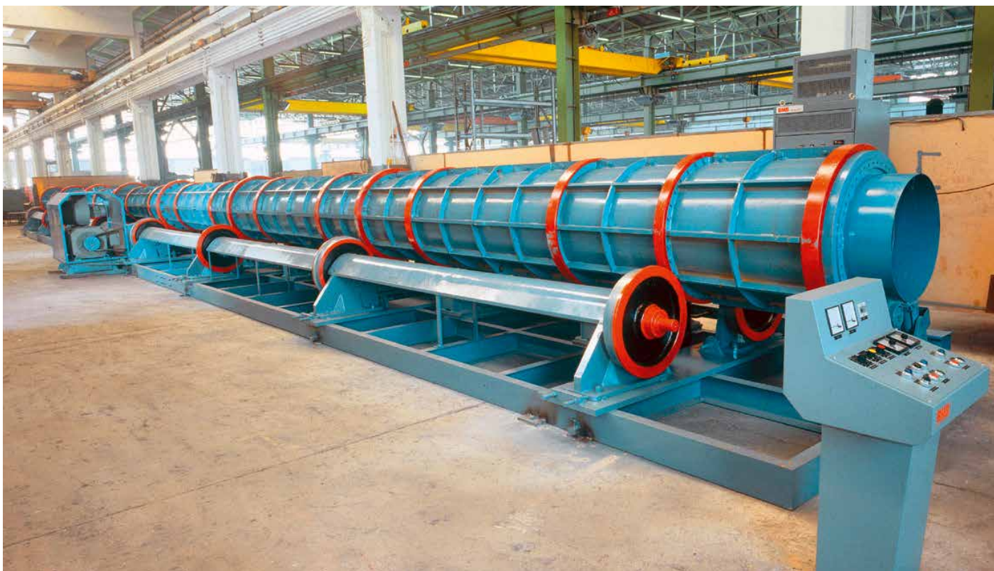
Форма для производства свай на центрифуге Spun Pile Mould on the Spinning Machine
