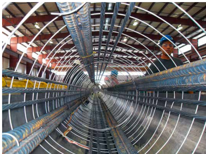
Пример армирования Example of Pole Reinforcement
