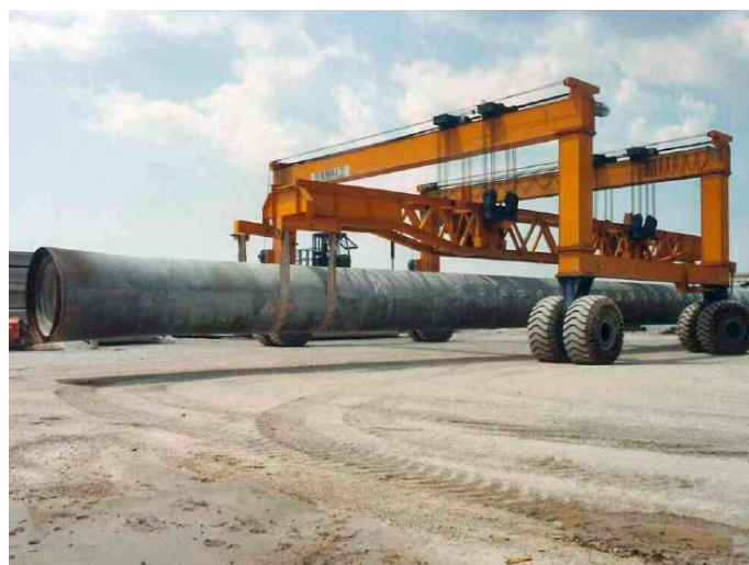
Кран для транспортировки свай длиной 40 м
