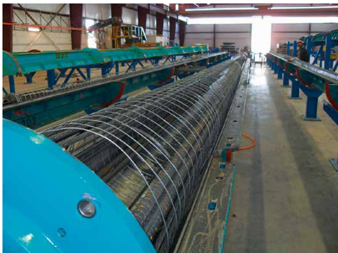
Форма для центрифугирования с арматурой Spun Pole Mould with Reinforcement
