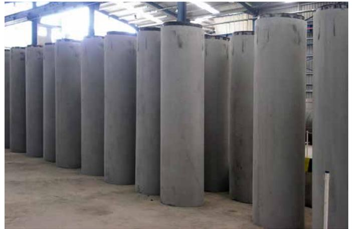
Tuyau en béton précontraint avec âme en tôle fini
