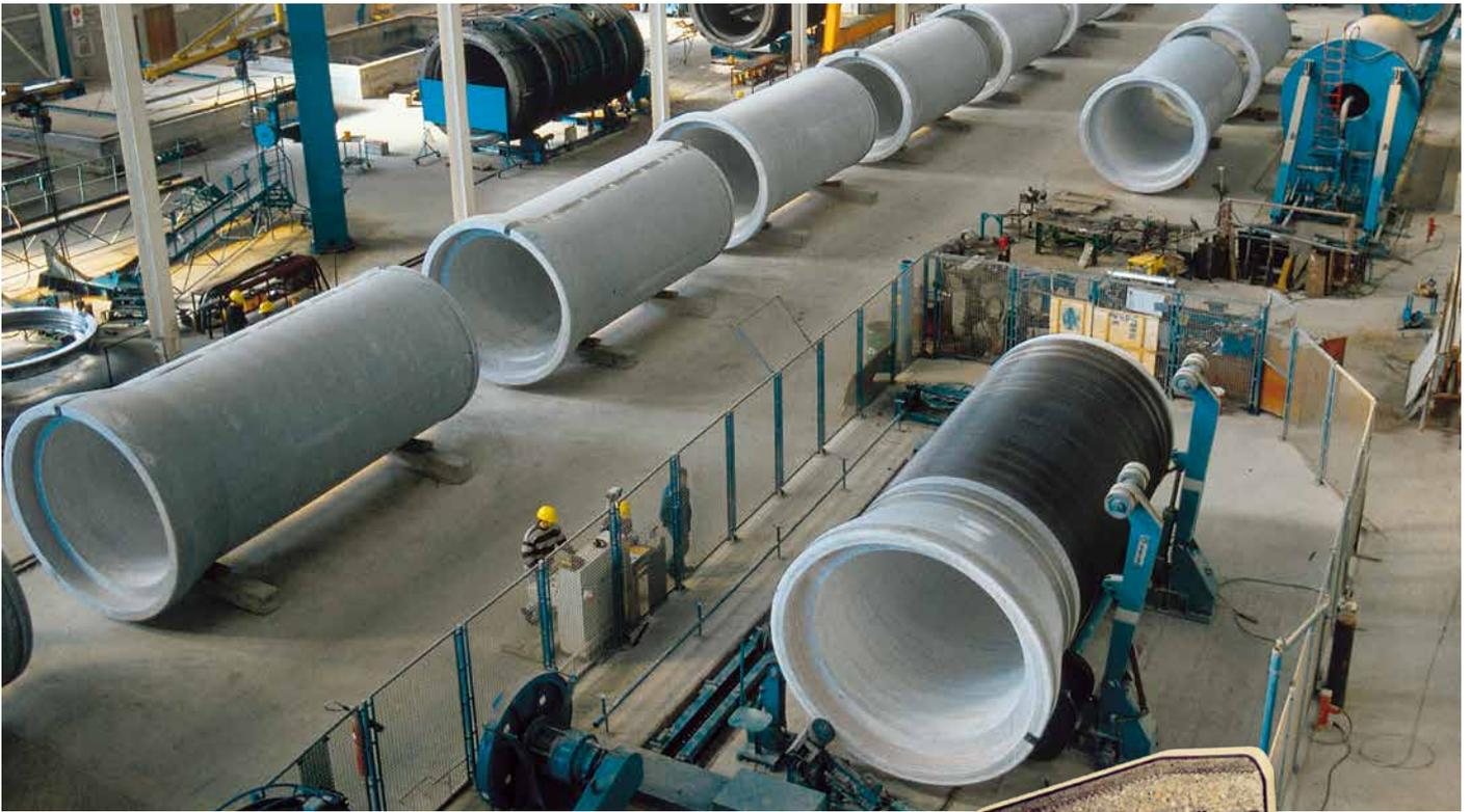
Layout d'une usine de tuyaux centrifugés en béton précontraint
