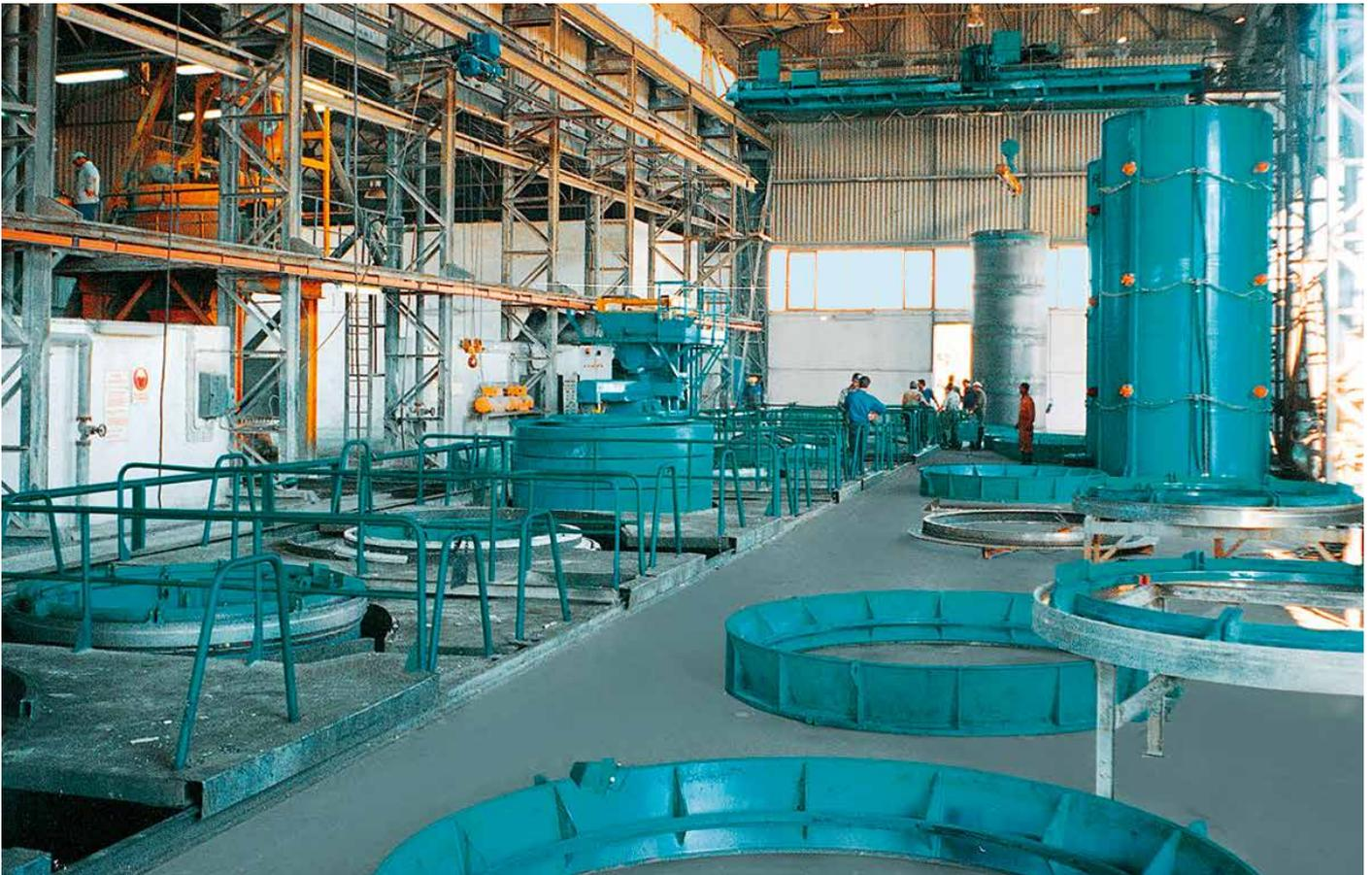
Zone de remplissage de moules et de frettage
