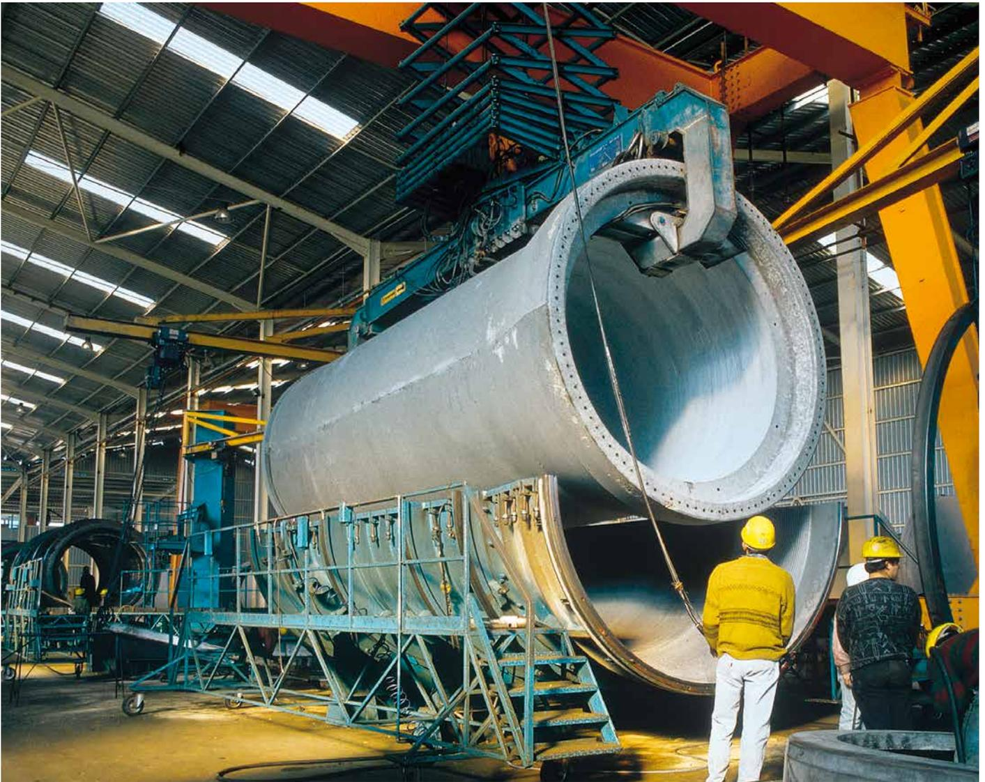
Procédé de démoulage d'un tuyau centrifugé en béton précontraint fretté
