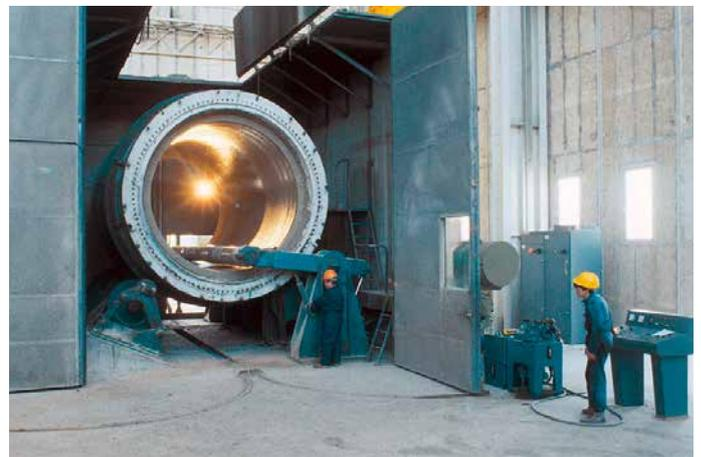
Centrifugeuse de tuyaux en béton
