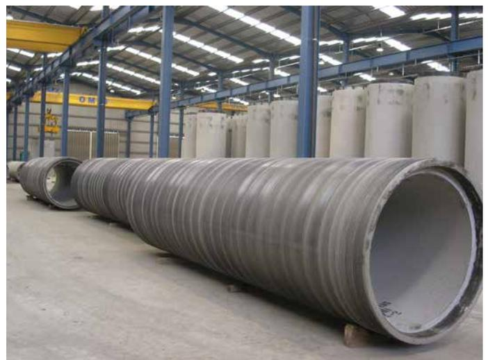
Noyau en béton après frettage
