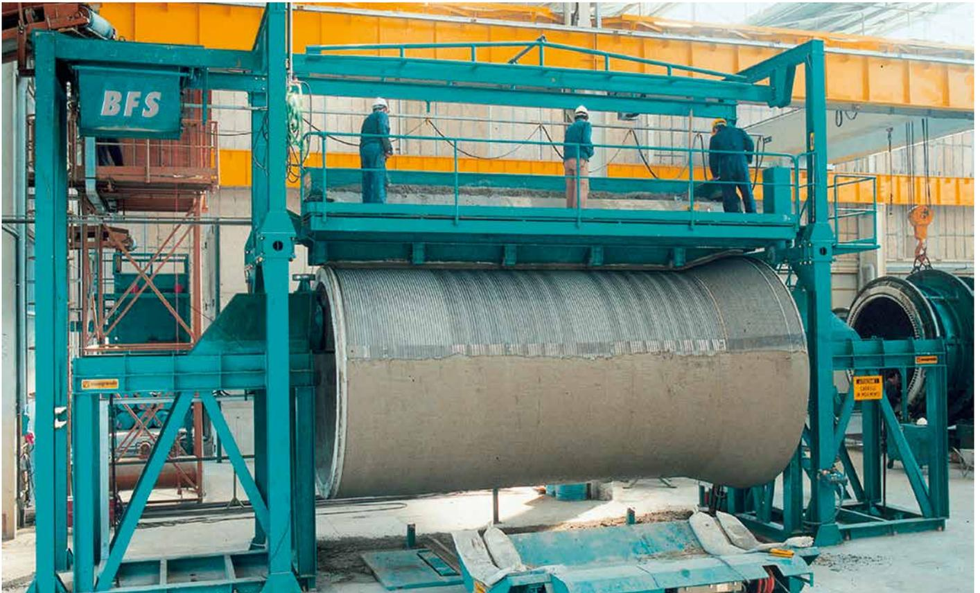
Machine à revêtir ; afin de protéger les fils d'acier contre la corrosion
