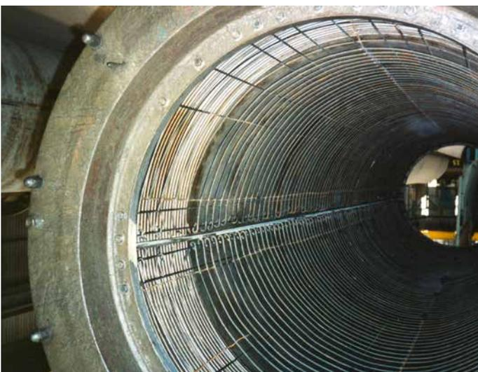
Moule FB renforcé par une cage et des fils longitudinaux de précontrainte
