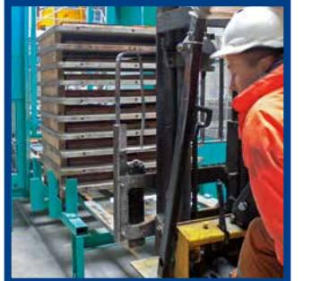
Magazzino d'impilaggio flessibile per pallet in legno, acciaio o plastica.
