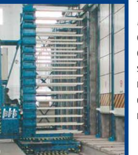
Tutte le linee automatiche **BFS** SLAB-FLEX sono completamente automatizzabili ed possono essere attrezzate con sistemi di movimentazione mediante finger-car, robot industriale o sistemi automatici di gestione magazzino.
