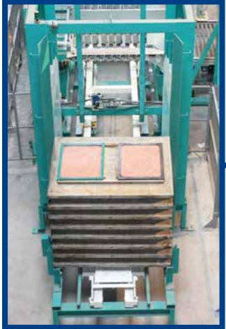
Stazione tampono o di caricamento per movimentare la pila di pallet tramite carrello elevatore o dispositivi di movimentazione automatici.
