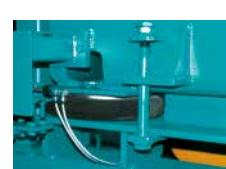
I più moderni metodi di calcolo garantiscono una perfetta compattazione del calcestruzzo. Per ottenere una distribuzione ad accelerazione assolutamente costante del materiale sull'intera superficie della tavola, le tavole CreaVib vengono ottimizzate mediante calcoli FEM.
