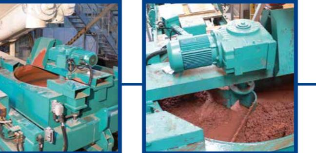
Stazione di dosatura multicolore con regolazione automatica del volume.
