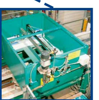
Stazione di spruzzatura dotata di sistema **BFS** Airless System per una spruzzatura regolata e precisa dell'olio dismante.
