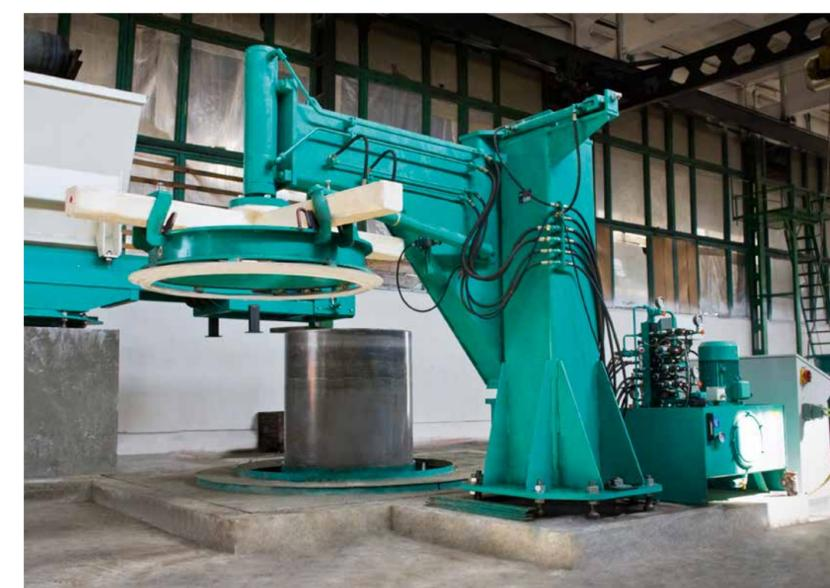
Основная рама установки оснащена поворотным прессующим кронштейном, с гидравлическим приводом; на который установлен прессующий блок для формирования раструба; с поворотным механизмом и креплением для прессующего кольца
