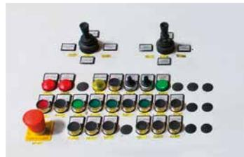
Электрическая система управления для ручного управления прессующим кронштейном; рассчитана для работы с 230/400 В, 50 Гц
