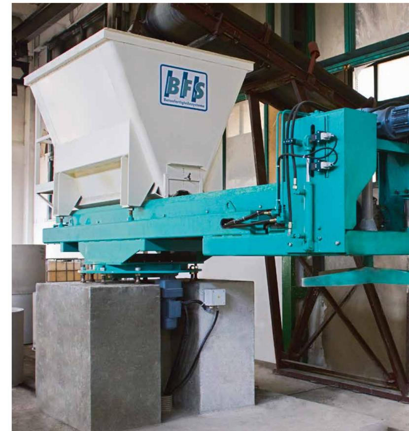
Устройство подачи бетона включает ленточный конвейер, бункер для бетона с емкостью примерно 1600 л, опорную раму на подшипниках для крепления на пол, заполняющее устройство с поворотом вручную и с ленточным конвейером, работающим от электропривода.
