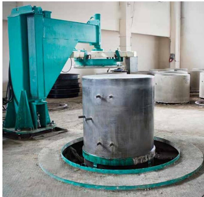
центральными вибраторами, встроенными во внутреннюю часть формы. Возможно оборудование преобразователем частоты.
