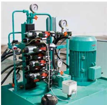
Гидравлический узел с гидравлическими цилиндрами, клапанами и гидравлическим управлением.
