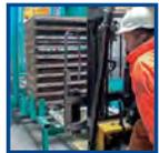
Flexibles Stapelmagazin für Holz, Stahl- oder Kunststoffpaletten.
