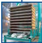
Puffer- oder Einschleusstation zum Einschleusen der Palettenstapel durch Stapler oder automatische Handlinggeräte.
