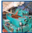
Mehrfarben-Beschickungsstation mit automatischer Volumenverstellung.
