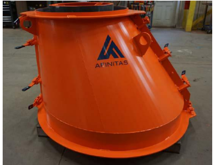
Manhole Cone Form
