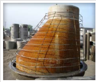
MANHOLE RISER CAGES
